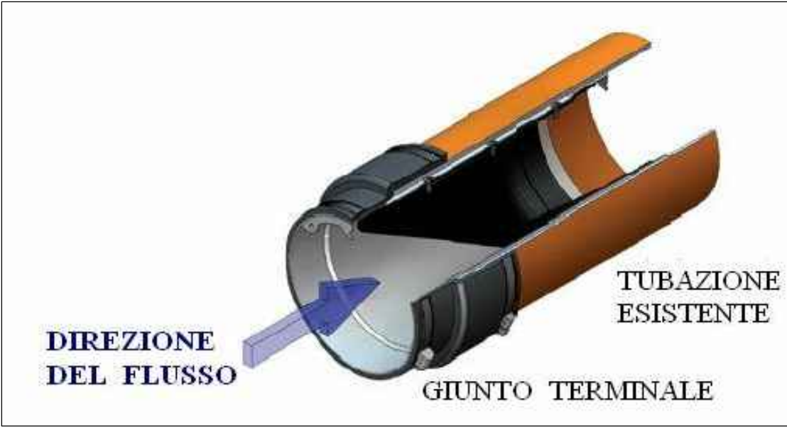
Particolare valvola antiriflusso tipo W.S. Ø 600mm
